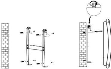
**Attention :** Avant la mise en marche de l'appareil assurez-vous que le radiateur soit correctement fixé au mur. Si le radiateur n'est pas de niveau, des problèmes peuvent survenir.
