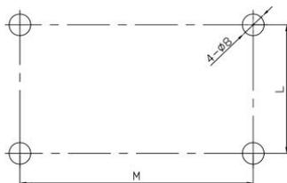
1 – Percer les trous dans le mur en suivant les étapes schéma 1
